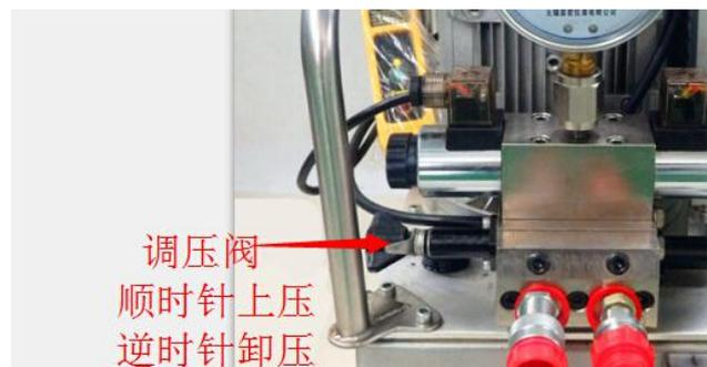
钮“绿色按钮”，电机开始运转，无异常后，再按住电磁换向按钮“绿色按钮”不放，高压左口出油，压力大小通过调压阀来调整，右口回油；松开“绿色按钮”，低压右口出油，高压左口回油，压力大小厂家已调整好，不要再调整。停止时需再次按住绿色按钮将调压阀卸压成零，松开后按下“红色按钮”，电机停止工作，泵站处于卸压状态，压力为零，操作结束。
